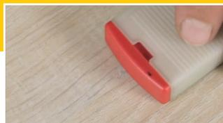
**DE** **Vorbereiten:** Lose Teile entfernen. Bei Echtholz-Oberflächen Schadensränder rund drücken. Bei künstlichen Oberflächen Schadensränder mit der spitzen Kante des Füllstoff-Hobels gerade nach unten abstechen.
