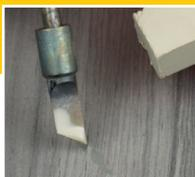
**Farbanpassung:** Zur Feinabstimmung die Maserung mit einem dunkleren Füllstoff nachahmen. Danach die Überstände wieder mit den Hobelrillen abtragen.
